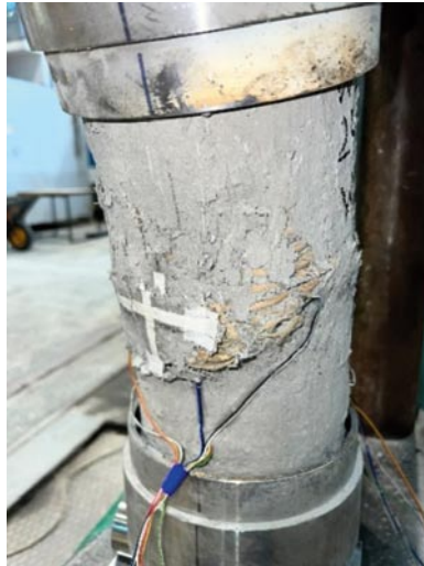
Rys. 8. Obraz zniszczenia w strefie bardziej ściskanej próbki walcowej, ściskanej mimośrodowo [12]
