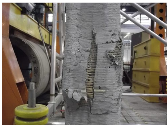
Rys. 7. Obraz zniszczenia mimośrodowo ściskanego słupa żelbetowego, wzmocnionego dwukierunkową siatką PBO-FRCM [11]
