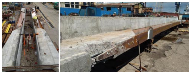
Rys. 3. Badania belek w skali naturalnej ze strefą przejściową na potrzeby mostu w Sobieszewie
